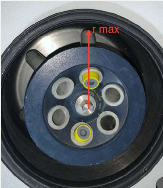
Şekil 1 “Açılı rotor” için r max ölçümü örneği
