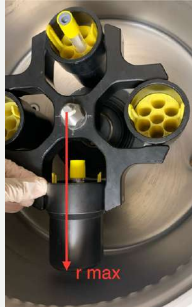
Şekil 2 “Açılır rotor” için r max ölçümü örneği
